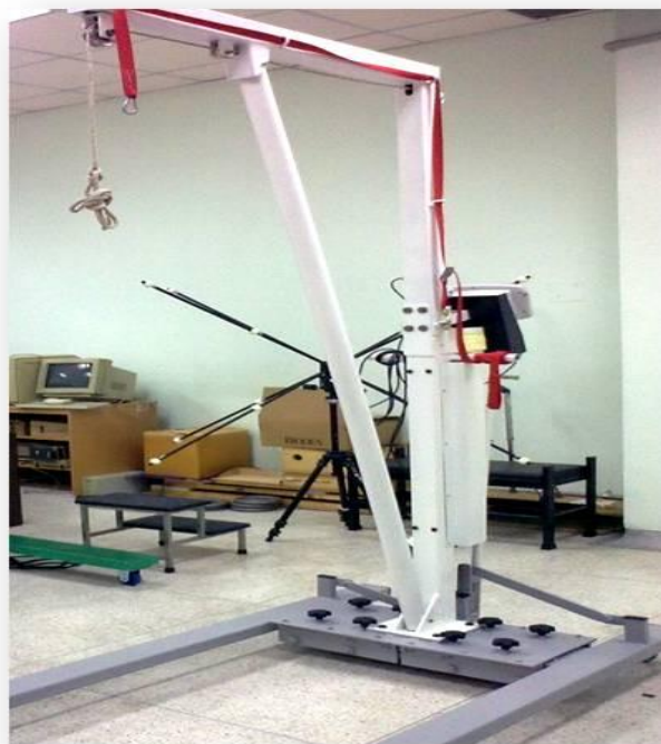
ภาพที่ 1 แสดงอุปกรณ์พุงน้ำหนักที่สามารถปรับความกว้างได้ที่ประดิษฐ์ขึ้นโดยร้มนภาและคณะ
