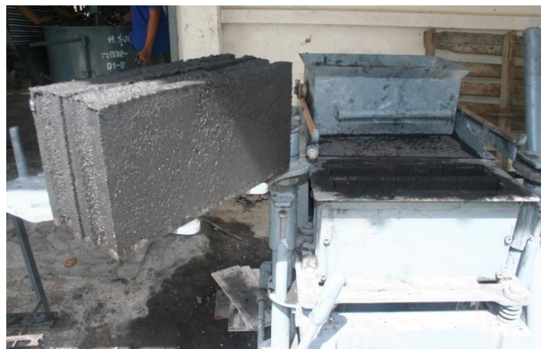
ภาพที่ 2 การเข้าแบบด้วยเครื่องไฮดรอลิก
