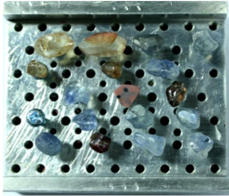
ภาพที่ 3 ฟลอยถูกติดลงบนหัวฉีดในชุดยึดจับ
