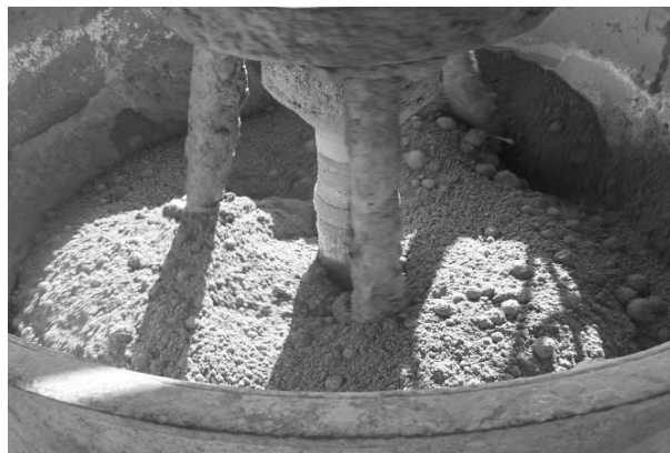
ภาพที่ 1 การผสมส่วนผสมสำหรับขึ้นรูปคอนกรีตบล็อก
