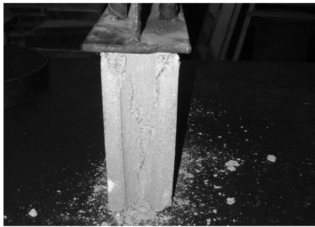
ภาพที่ 3 การทดสอบกำลังอัดของคอนกรีตบล็อก
