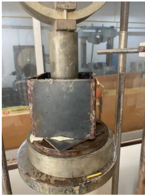
ภาพที่ 4 ลักษณะการขึ้นรูปชิ้นงานจริงด้วยการอัดแรงจนน้ำยางซึมล้นออกมา
