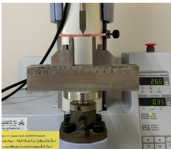
ภาพที่ 2 แสดงการทดสอบค่าความแข็งแรงต่อการโค้งงอของชิ้นงาน
