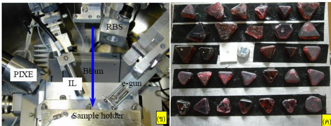
ภาพที่ 3 (ก) แสดงเครื่องเร่งอนุภาคลำไอออน (ข) ภายในอุโมงค์วิเคราะห์ (chamber) ประกอบด้วยหัววัด PIXE (ค) ตัวอย่างพลอยสปิเนลที่ติดอยู่บน sample holder
