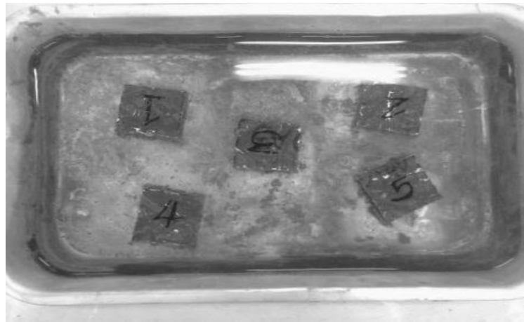
รูปที่ 4 แสดงการทดสอบการดูดซึมน้ำของแผ่นซีเมนต์บอร์ด
