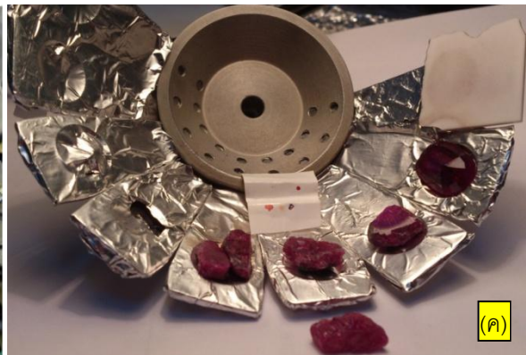
ภาพที่ 4 แสดงเครื่องเร่งอนุภาคด้วยลำไอออน (ก) ภายในอุโมงค์ (chamber) ประกอบด้วยหัววัด PIXE และ IL (ข) พลอยทับทิมที่ติดอยู่บน holder (ค)
