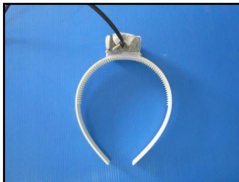
ภาพที่ 5 การติดเซนเซอร์วัดความเอียงบนที่คางผม
