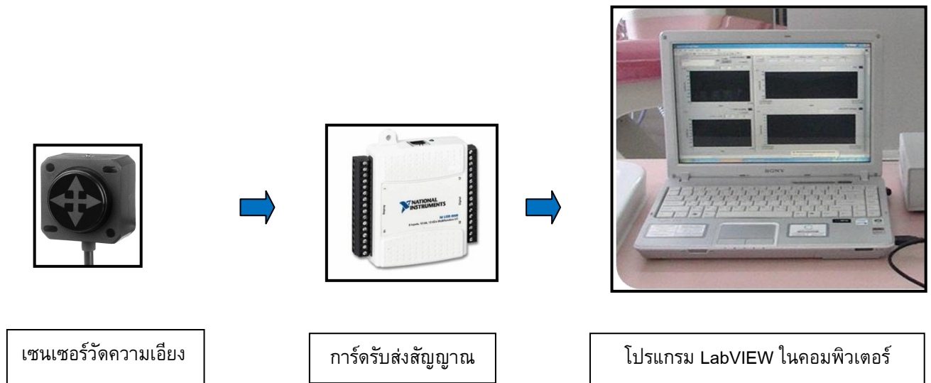
ภาพที่ 3 ส่วนประกอบของเครื่องมือวัดเสมือนจริง
